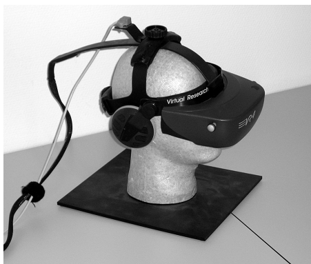
Figuur 5. De head mounted display van de eerste VR-installatie uit 1996.
