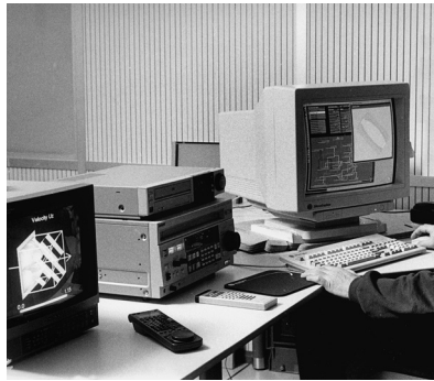
Figuur 3. Apparatuur in het visualisatiecentrum in 1996, met v.l.n.r. de videomonitor, de laser video disk recorder en het beeldscherm van het sgi Crimson workstation, waarop ondermeer een avs-netwerk staat afgebeeld.
