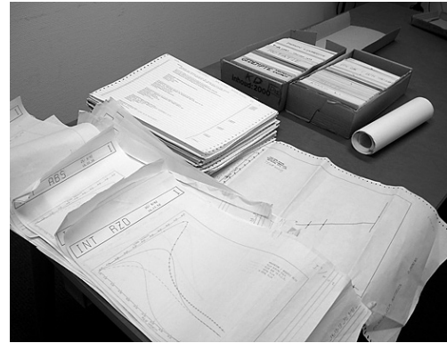
Figuur 5. Hiermee had de latere directeur van het RC, Koos Duppen in 1982 te maken als hij op het Rekencentrum was om zijn berekeningen te doen en zijn KOMPLOT-grafieken te maken, die we linksonder zien. Rechtsboven twee dozen met ALGOL 60-programma's op ponskaarten en daar tussenin een stapel regeldrukkeruitvoer, met bovenop een afdruk van een programma 19 .
