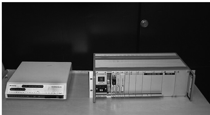
Figuur 4. Een modem en een brug, gebruikt om twee netwerken via een telefoonverbinding te koppelen, omstreeks 1988
