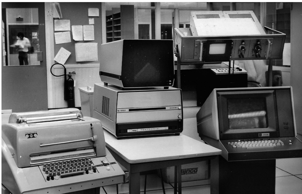
Figuur 1. Enige apparaten die staan te wachten om weggegooid te worden. Links een teletype en rechtsonder een Tektronix 4010 grafische terminal.
