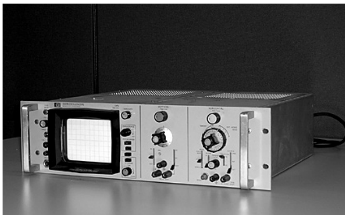
Figuur 10. Oscilloscoop als eerste grafische terminal aan PDP9 computer, 1969. Nog aanwezig in het rc.
