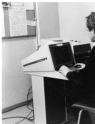
Figuur 11. Tektronix grafische terminal met hardcopy apparaat in rc, bediend door de auteur van dit stuk rond 1980.
