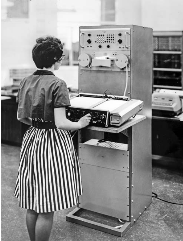
28 Een medewerkster van het Rekencentrum bedient de zogenaamde plotter, een apparaat om uit de gegevens van de computer grafieken samen te stellen. Collectie Universiteitsmuseum Groningen.
