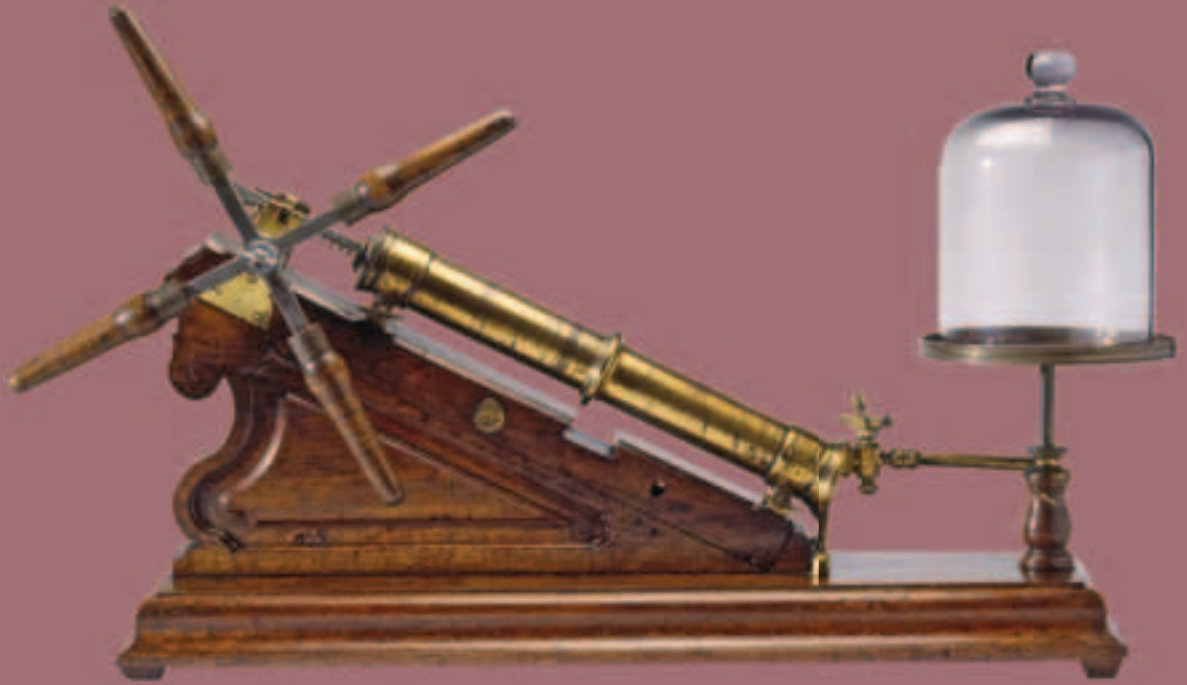
K14 Enkelvoudige luchtpomp naar ontwerp van Jan van Musschenbroek. Museum Boerhaave (bruikleen van Universiteitsmuseum Groningen).
